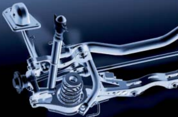
La suspensión trasera independiente multi-link proporciona gran sensación de seguridad y estabilidad en carretera.
